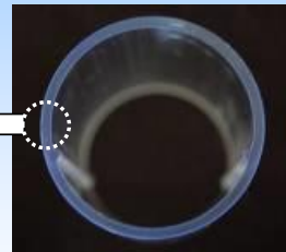
2種3層PC/PENパイプ(リブ付)断面 (PENは透明ですが紫外線を吸収し少し青く発色します)
